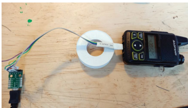
Bild 1: etwas „frickeliges“ Anlöten des Kabels an einen USB-Micro-B-Stecker, Gelb = 5 = GND, Grau = 1 = +5V
