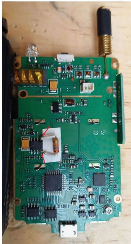
Abbildung 7: Platine nach Anlöten des Widerstandes beim LM4890
