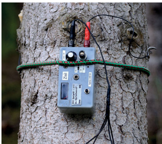
Installierter 80m ARDF-Sender mit 8m Antennendraht am Baum und 4 Radialen. (Zielsender beim Bewerb in Innsbruck)
