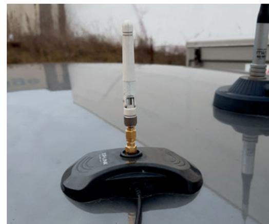
Antenne mit 2 Adaptern um 2,5 cm erhöht
