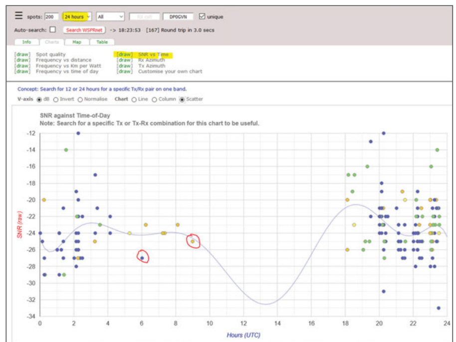
Abb. 5: „SNR vs. Time“ Chart für TX-Station DPOGVN (24 Stunden auf allen Bändern am 1.1.2020).
