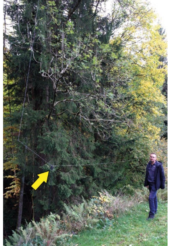
Loop-Antenne mit Übertrager und Antennenanschluss im Fußpunkt (Pfeil), daneben Holger – OE9GHV, aufgenommen im Oktober 2019.
