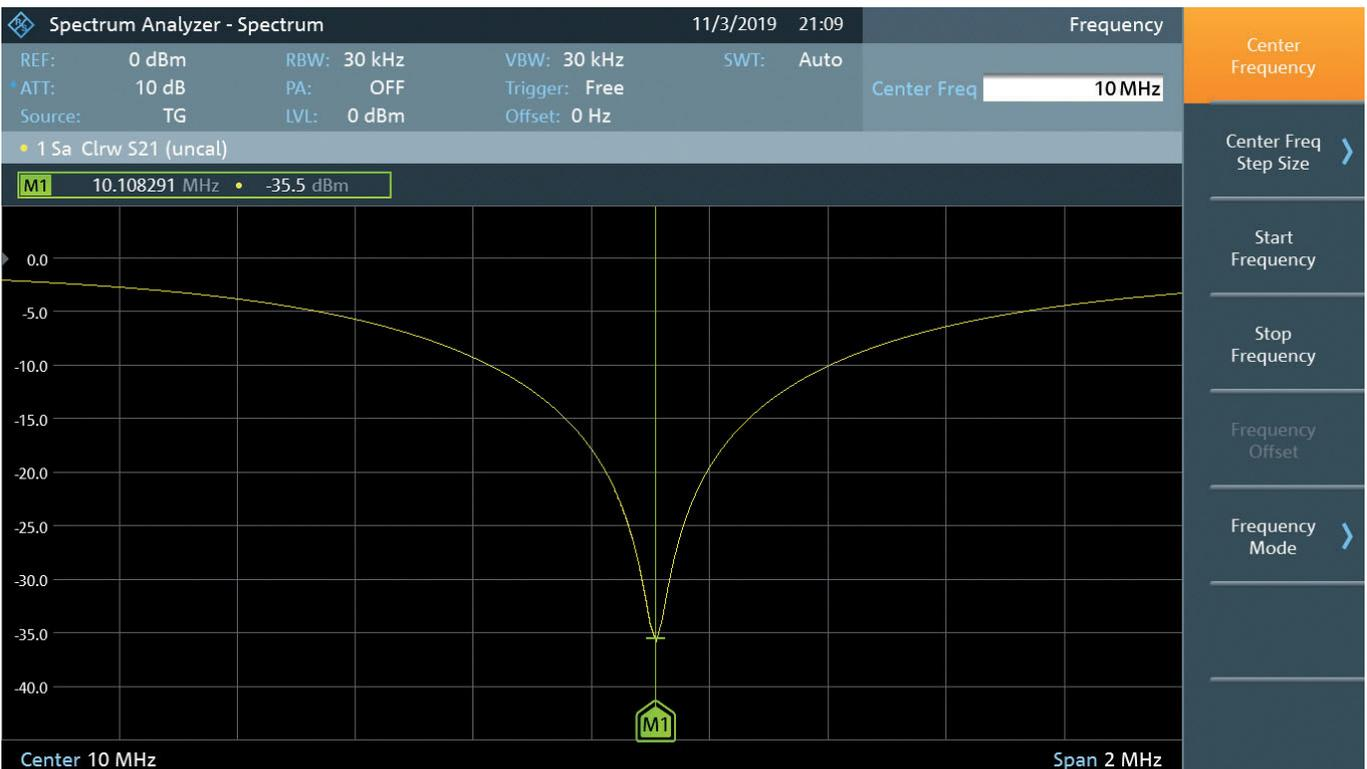
**Messbeispiel:** Trap für eine Endfed-Antenne auf 10,1 MHz in Serienschaltung.
