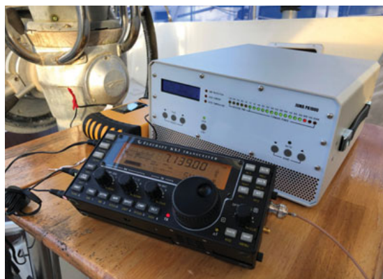
Elecraft KX3 mit Juma-PA, ein 6 Kilo leichtes Kraftpaket im Handgepäck
