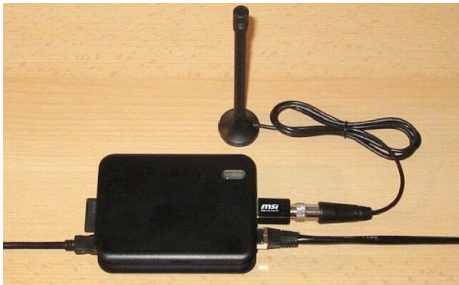
HAMServerPi: RaspberryPi mit DVB-T-Stick (MSI Digi Vox mini Air) und Antenne für APRS-Empfang
