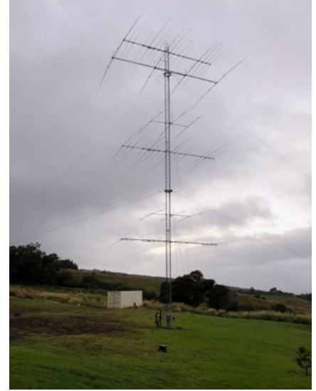
Antennenanlage von Bill KH7XX: 3 gestockte Opti-OB16-3, 4el 40m Mono-Opti, 2 WARC Yagis
