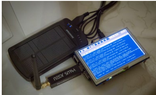
oben: mobiles Telemetrie Wettersonden Empfangsequipment bestehend aus Raspberry-SDR Stick mit RX Antenne-Mini Bildschirm und Powerpack
