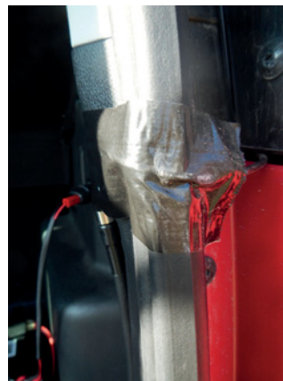
Kabelschutz an der Dichtung
