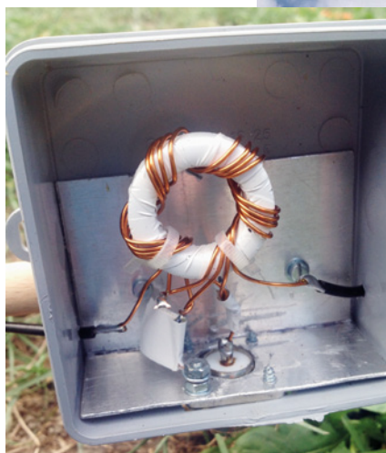
Bild oben: der Balun im Anschlusskästchen (Foto: OE1KFR)
