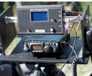
NUE-PSK Digital Modem, FT-817 von OE8FFR
