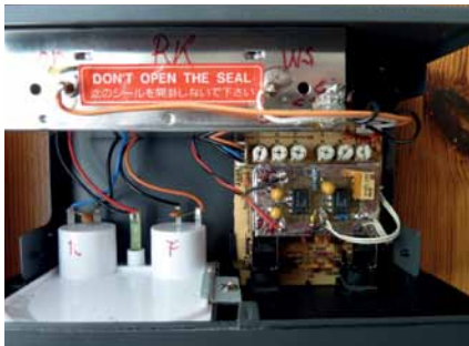
Bild 8: Nachdem ich in mein SWR-Meter einen OPV als Impedanzwandler sowie einen
