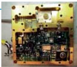
DRO Bauelemente sind Surplus Bauteile aus Richtfunkgeräten, die heute nur mehr solche Methoden zur Signalvervielfachung verwenden. Feste Vervielfacherketten mit konkreten Bauteilen und Filterbänken sind heute nicht mehr der Stand der Industrie Technik. Anstelle von DROs werden auch YIG Oszillatoren verwendet.
