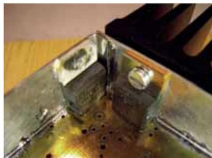
Die gelieferten SMA Buchsen sind für Drahtanschluss ausgelegt (Röhrchen) der Innenleiter ist für den Anschluss an die Streifenleitungen zu lang. Den Innenleiter auf eine Länge von 1,5mm ab Flansch kürzen (Achtung! Messing hart), Schnittgrat abfeilen. Den runden Innenleiter mit einem Durchmesser von 1,3mm mit einer Feile auf max. 1/4 des Durchmessers anfeilen um eine gerade Auflagefläche auf der Streifenleitung zu schaffen. **Tipp:** Der Innenleiter lässt sich drehen (siehe Foto links unten).
