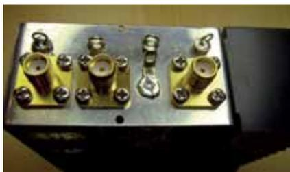
Neben der RX-SMA Buchse, ist Innen links (neben der Streifenleitung) eine Kehl naht zur Gehäusewand auf eine Länge von 3mm zu löten. Siehe auch Seite 9, schraffierter Balken, rechts mittig. „RF ground“ für die RX Eingangsstufe.
