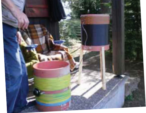
Bild oben: Variometer (OE5PRL) und Verlängerungsspule (OE5MW) für die Langwellenstation.
