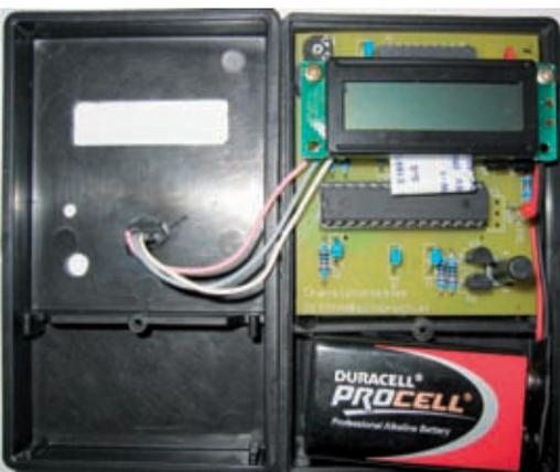
Transistortester von OE5GHN geöffnet
