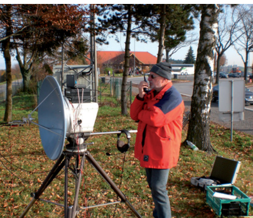
OE3WOG mit 70 cm-Querverbindung, 122 GHz-Transverter, Autobahnraststelle Strengberg, JN78HC
