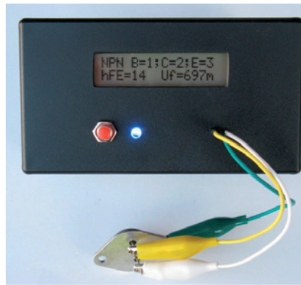
Der Transistortester in der Ausführung „Bastelprojekt“.
