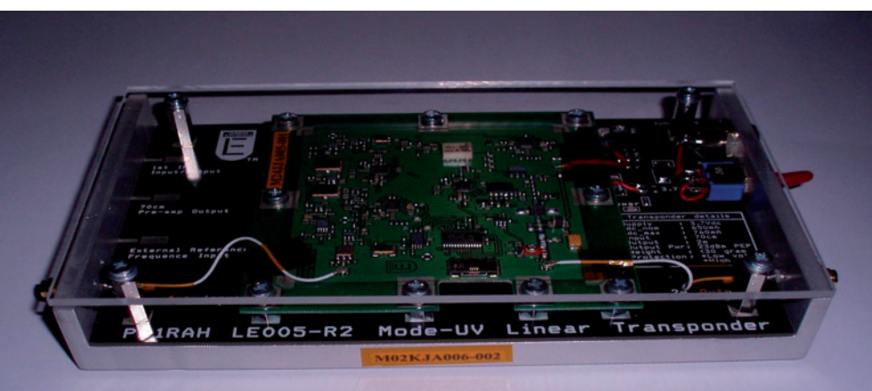
0,2 W PEP U/V-Linear-Transponder von PE1RAH für Ballonstarts.
