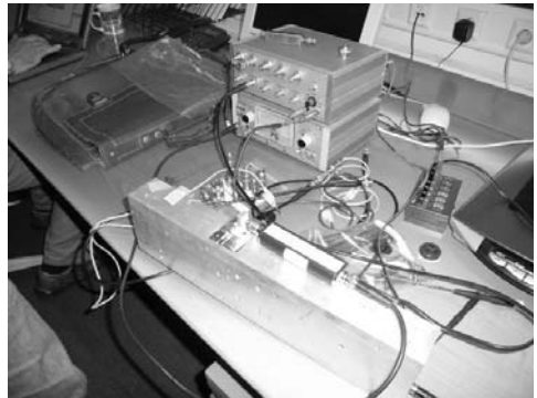
24 GHz Empfängerrauschzahlmessung, OE3WOG (2,1 dB)
