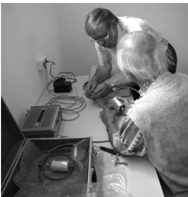
DJ6BU und DL2AM beim Messen der Leistung auf 122 GHz (360 microw)
