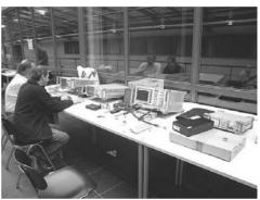
Messgerätestand von R&S mit 26,5 GHz Spektrum Analyzer, 20 GHz Vector Network Analyzer und einem 20 GHz Messender
