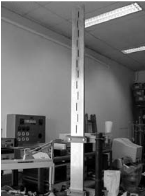
Die Hohlleiter-Schlitzenantenne bei der Messung an der TU Wien
