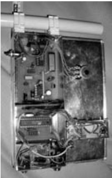
Der eigentliche Prozessorprint (40×46 mm) wird über kurze Drahtbrücken angeschlossen und kann theoretisch auch später nachgerüstet werden. Auf Grund des geringen finanziellen Aufwandes ist das aber eigentlich gar nicht sinnvoll.
