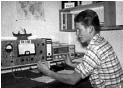
1962: Geloso VFO, 6146 PA, Heathkit HR10 Empfänger und W3DZZ.
