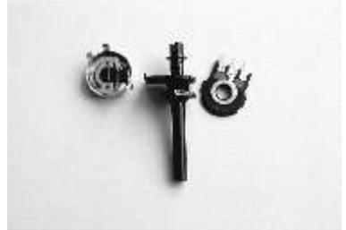
Bild 6: Ein zerlegtes Potentiometer
